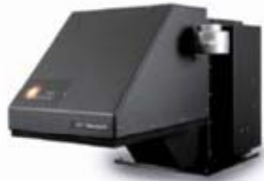
N&K-薄膜測厚儀 量測TCO和p-i-n薄膜厚度、消光系數和反射率
