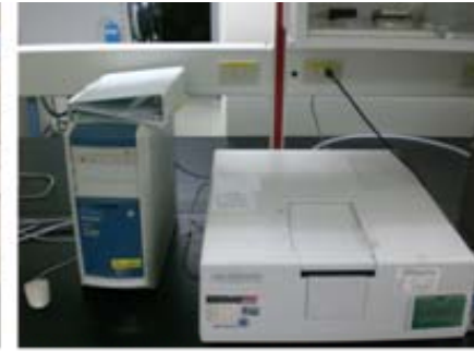
UV-vis-紫外-可見光光譜儀 量測TCO和p-i-n可見光穿透率
