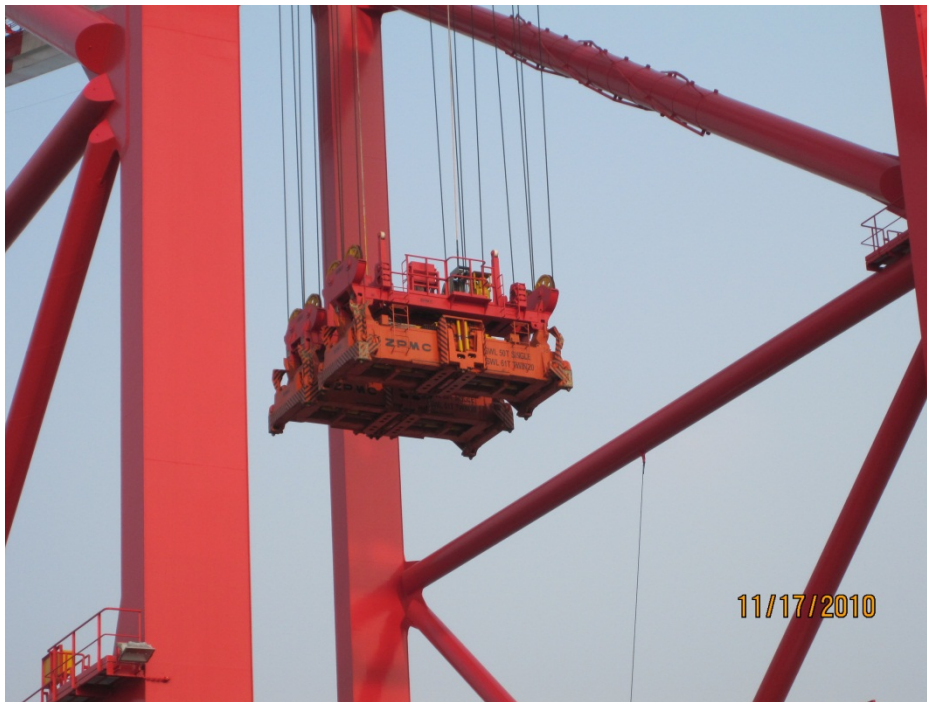
圖 13. 橋式起重機之多吊夾櫃器
