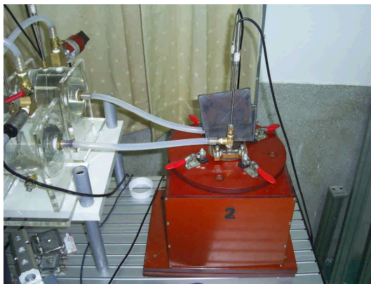
圖 4.1、熱阻測試實驗系統
