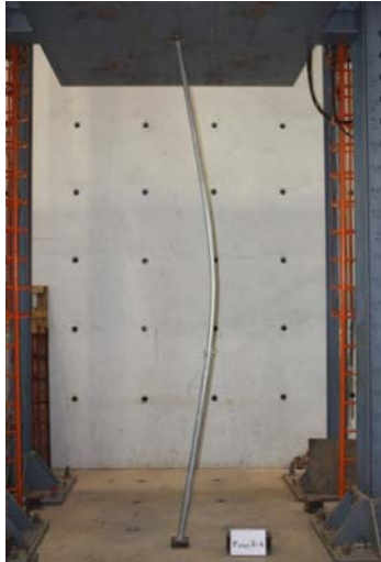
照片 4 單根可調鋼管支柱之試驗破壞情形
