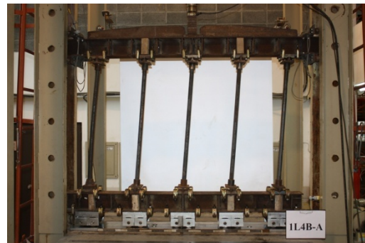
照片 9 單層組搭四跨系統靠桿效應試驗結果
