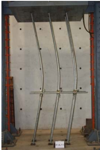
照片 5 可調鋼管支柱 6 支結構系統試驗破壞情形
