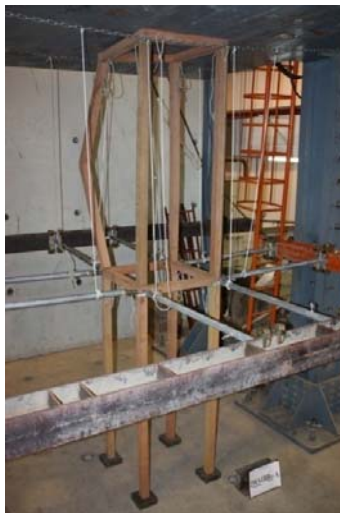
照片 12 木支撐雙層組搭雙向側撐類型破壞情形
