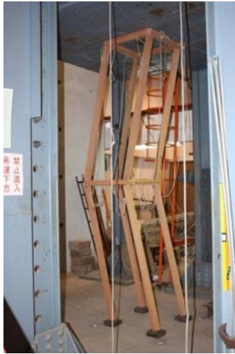
照片 11 雙層組搭無側撐木支撐系統破壞情形
