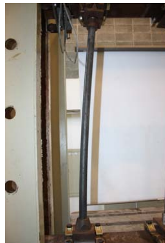
照片 10 靠桿效應試驗強柱破壞情形
