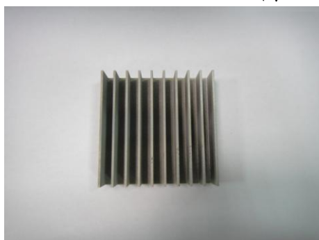
圖 5-47 方形鰭片—田口優化設計模型
