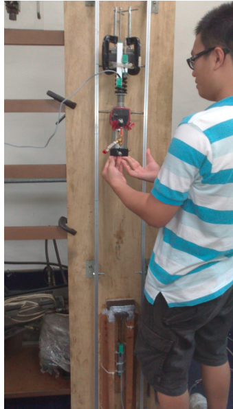
圖一、輔助抑制衝擊負載結構 與量測實驗裝置實體圖
